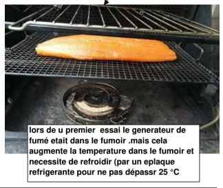
le fait de séparer le fgenerateur de fumée du fumoire . facilite la mise en œuvre
