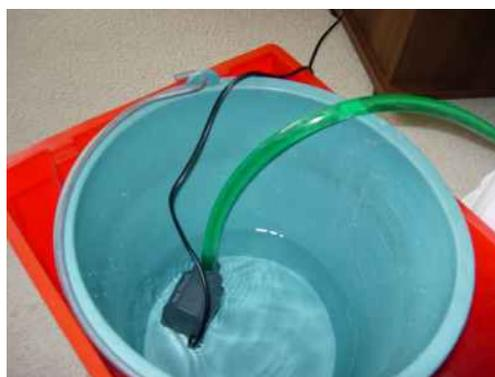
Remplissage (Si le tube est dans l'eau il est important de retirer ce tube en fin de remplissage sinon ce tube se transforme en siphon dès l'arrêt de la pompe et vide l'aquarium dans le seau puis le salon !)
