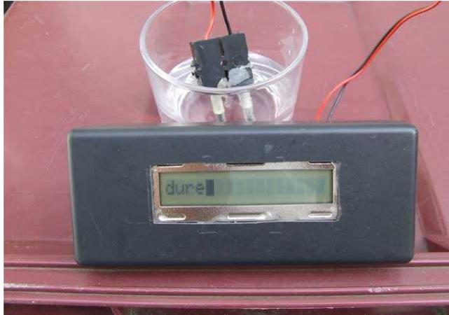
ce montage se compose d'une sonde (composée de 2 clous dde diametre 2mm en inox fixés dans un domino )
