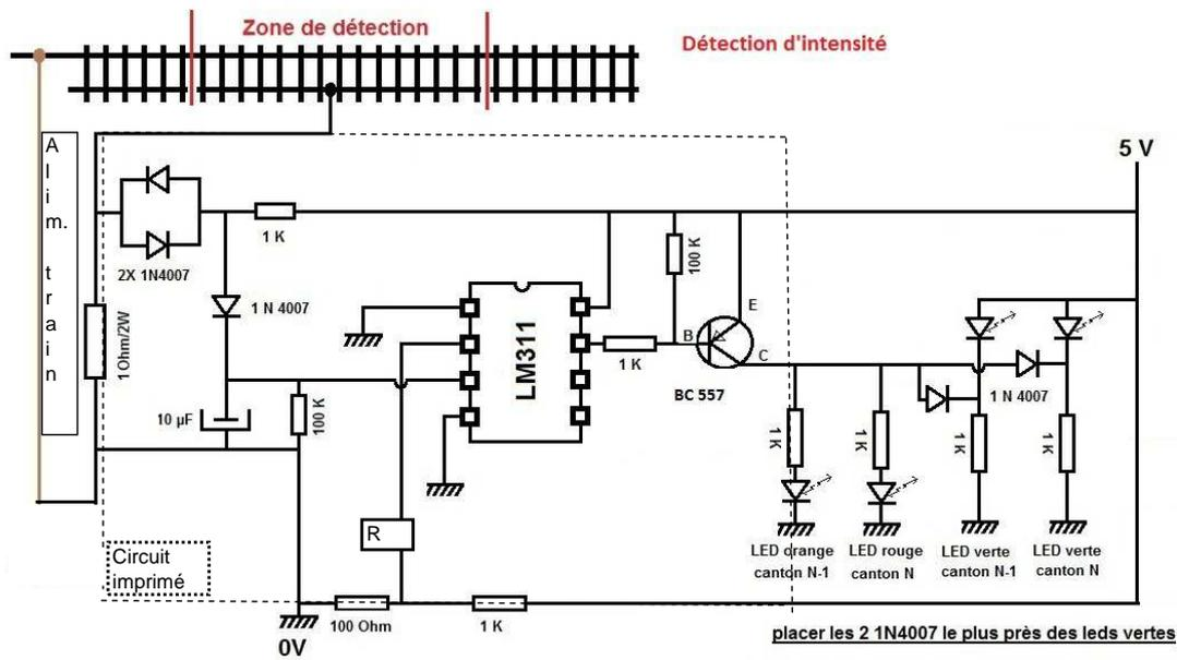
Quand un courant circule dans la résistance de 1 Ohm, la sortie du LM311 alimente la led rouge du canton N, la led orange du canton N-1 et courtcircuite les leds vertes des cantons N et N-1 par les diodes 1N4148 ou 1N4007 ( le courant préfère emprunter cette diode que la led verte )
