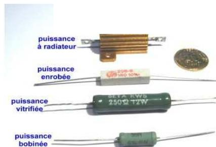
Quand on connaît la resistance on doit vérifier qu'elle va supporter l'intensité qui va la traverser
