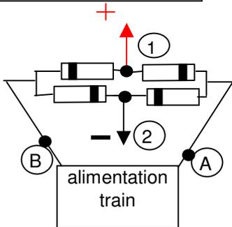
On peut ajouter un condensateur entre 1 et 2 pour éviter les scintillements (100µF 25V).
